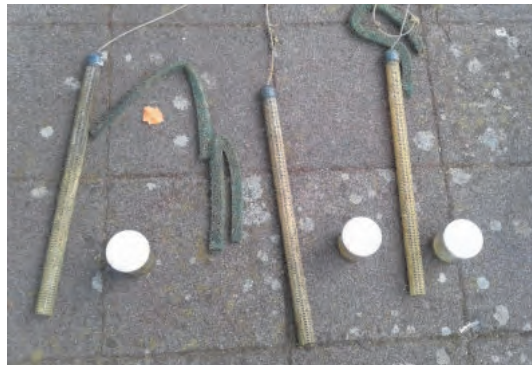
Figure 10 : Photo de 3 cellules Prebio : 3 tubes maillés et leur mousse
